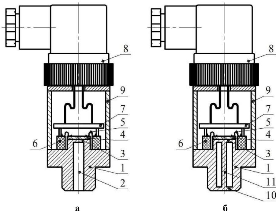
Рисунок 2 - Упрощенная конструктивная схема датчика
