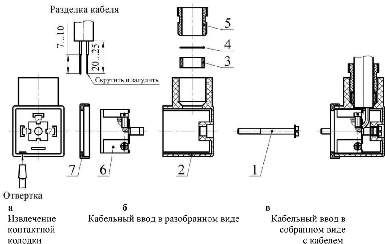
**Рисунок 3 - Порядок подсоединения кабеля к кабельной части разъёма**
