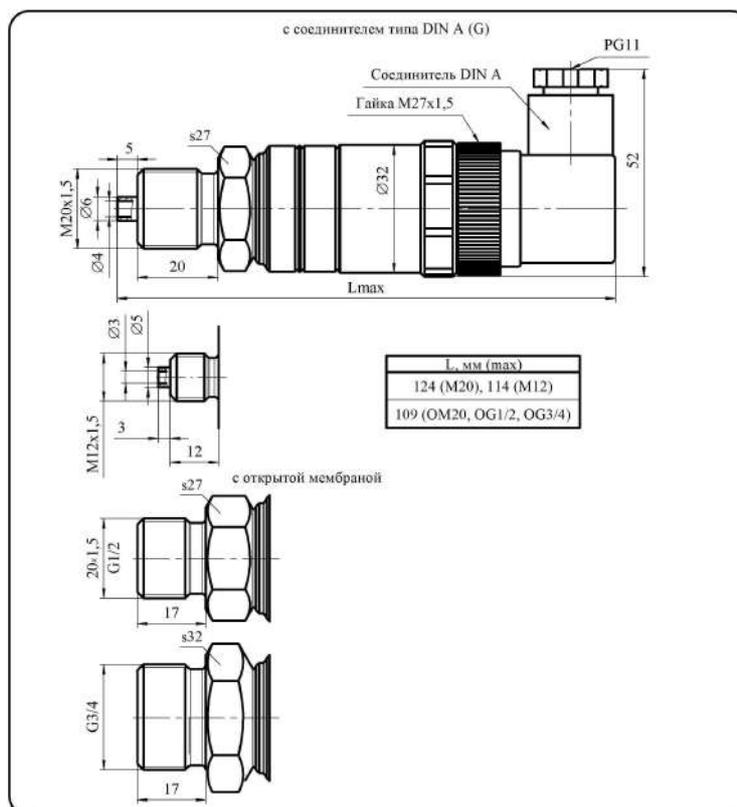
Рисунок 1 - Габаритные размеры и тип присоединительного штуцера
